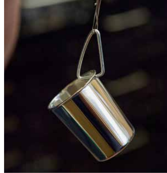
Vor dem Versilbern wird ein Werkstück mit leitfähigem Kupferdraht „angedrahtet“.
