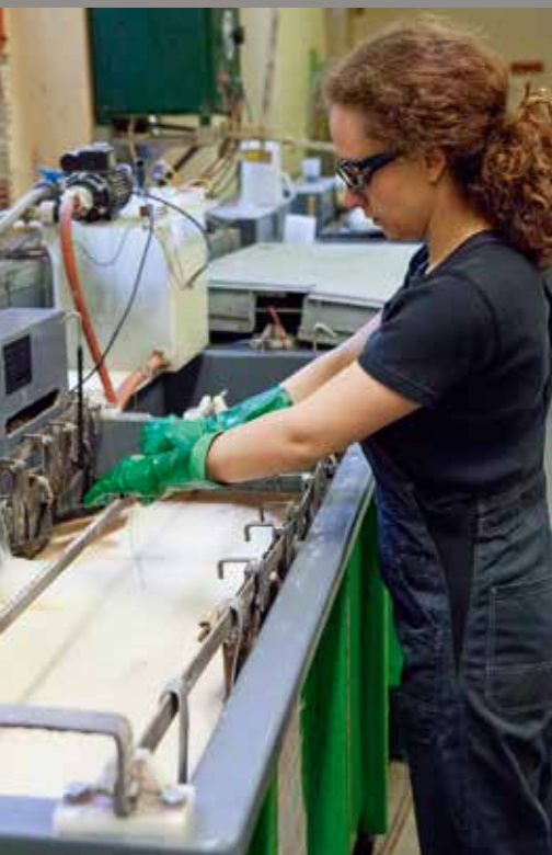
Für die Elektrolyse setzt Maxi Hänsch den Becher unter ein Ampere Strom. Das Versilbern beginnt.
