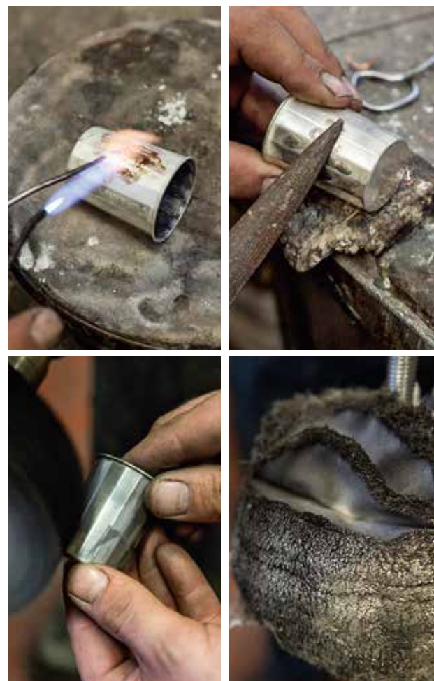
Die Gravur eines Bechers wird zugelötet und die Lötstelle bündig verfeilt. Vor dem Versilbern erfolgt noch die Politur mit weichen Baumwollappen.
